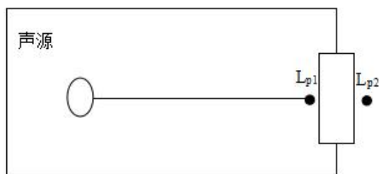
图 4-1 室内声源等效为室外声源图例
