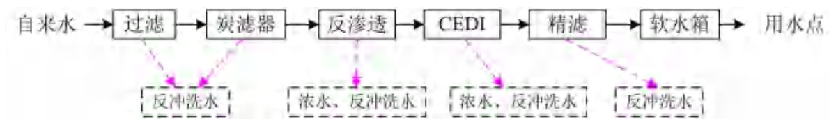
图 3.5-1 制纯水装置工艺流程图
