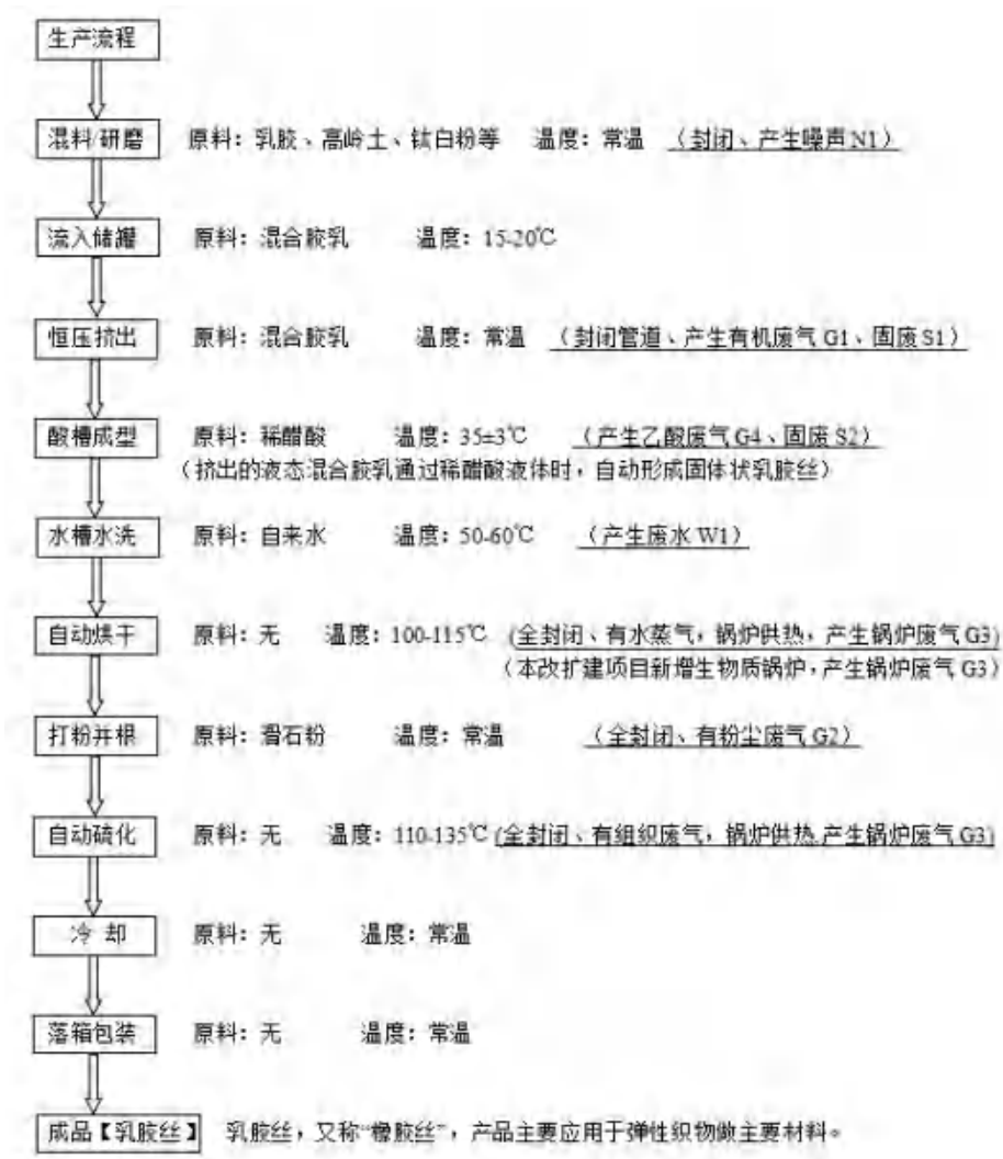
图 3.6-1 乳胶丝生产工艺流程图
