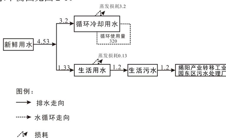
图 2-1 水平衡图 (单位:  $\text{m}^3/\text{d}$ )
